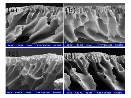
Fig. 3. Cross-sectional SEM images of the prepared membranes (a)  $M_1$ : Unfilled PES, (b)  $M_2$ : Fe<sub>3</sub>O<sub>4</sub>/OCMCS 0.05 wt. %, (c)  $M_3$ : Fe<sub>3</sub>O<sub>4</sub>/OCMCS 0.1 wt. % and (d)  $M_4$ : Fe<sub>3</sub>O<sub>4</sub>/OCMCS 1 wt. %.
